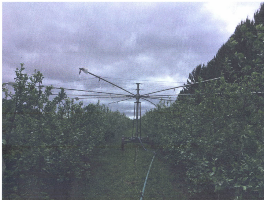
Figura 1. Simulador de chuva usado no presente experimento, realizado na Estação Experimental de Fruticultura de Clima Temperado da Embrapa Uva e Vinho.
