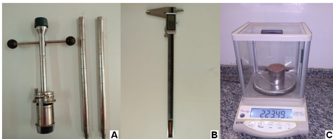
Figura 1. Extrator tipo Uhland (A), paquímetro digital(B) e pesagem de amostra de solo seco no cilindro volumétrico (C).
