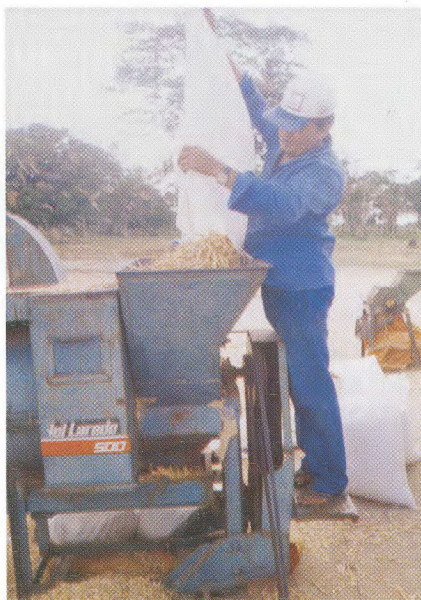
FIG. 4 - Trilhadeira em funcionamento na debulha de feijão caupi.
