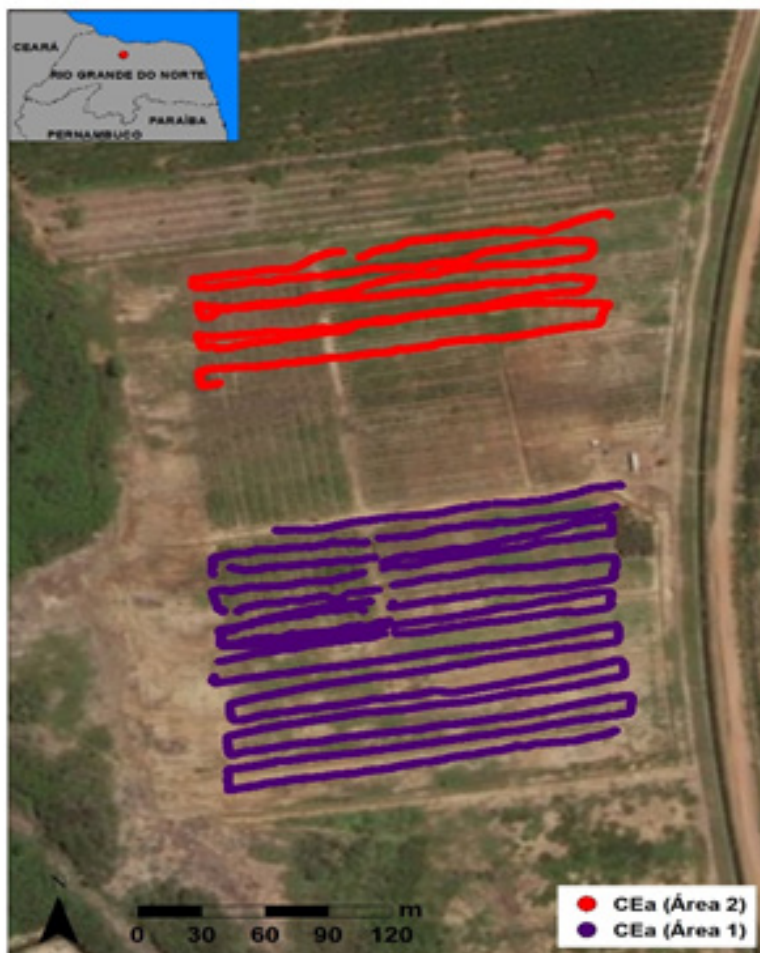
Figura 1. Localização da fazenda no Município de Alto do Rodrigues, RN, e disposição das leituras de condutividade elétrica aparente (CEa) do solo realizadas pelo equipamento EM38-MK2.
