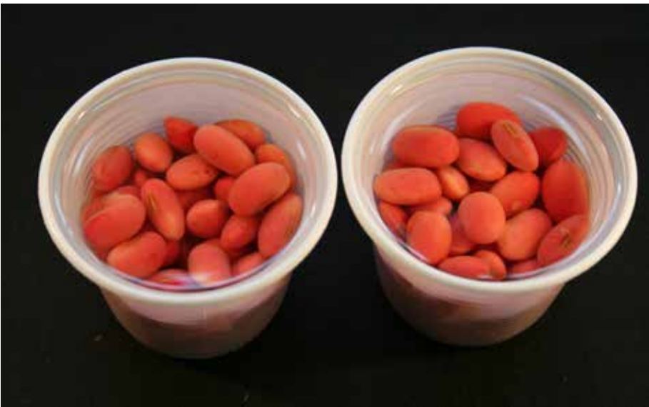
Figura 7. Sementes de soja coloridas pela solução de tetrazólio, após lavagem em água comum, prontas para serem avaliadas.
