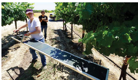
Figura 11. Equipamento para determinação da área sombreada pelas videiras (PAS). Califórnia, EUA. Fonte: Fidelibus (2016).
