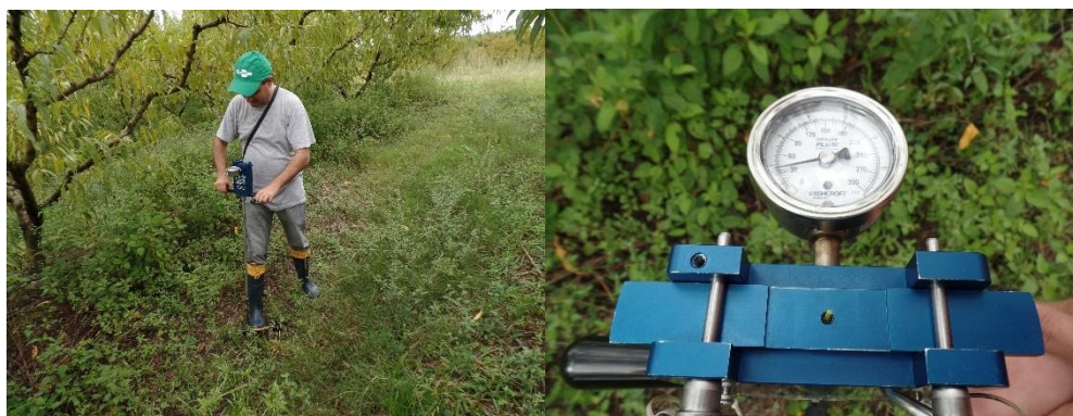
Figura 1: Câmara de Scholander portátil em operação no manejo da irrigação da cultura do pessegueiro. Fonte: Luciano Recart Romano
