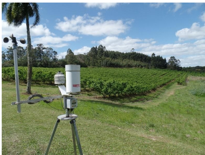
Figura 2: Estação meteorológica automática utilizada no manejo da irrigação em pomar de pessegueiro.
