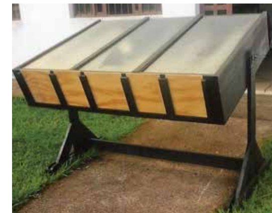
Figura 1 - Coletor solar construído e utilizado na desinfestação do substrato.
