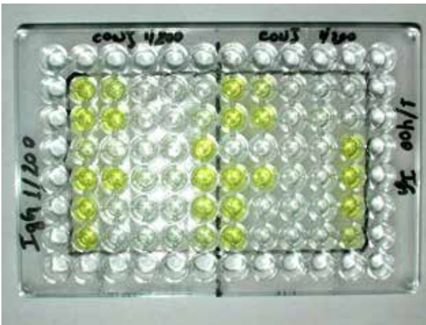
Figura 12: Teste imunológico ELISA utilizado na indexação de viroses. Plantas com infecção mostram orifícios de cor amarela.
