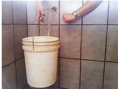
Figura 4. Método de estimativa de vazão de água em tubulação. Foto: Fabrício P. Rezende.
