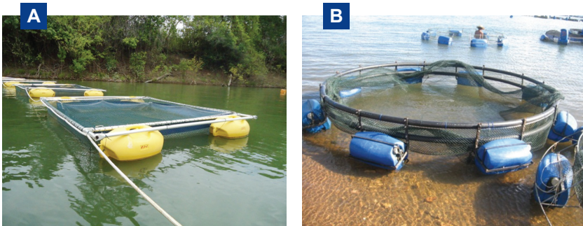
Figura 22. Detalhes da estrutura de tanques-rede (A) retangular e (B) circular: flutuadores, armação, tela de contenção. Fotos: Adriana F. Lima.
