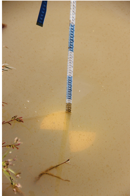
Figura 3. Disco de Secchi. O contraste entre as partes brancas e pretas deve ser observado até o momento em que as duas cores não podem mais ser distinguidas sob a água. Nesse momento, utiliza-se a fita métrica acoplada ao disco para medir o grau de transparência da água, dado em centímetros.
