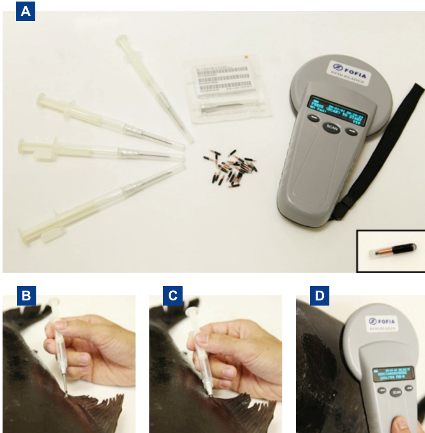
Figura 2. Processo de implante do tag no peixe. (A) material usado para marcação dos peixes com tags , e em destaque o tag . (B) local aonde deve ser inserido o tag . (C) inserção da agulha até o final. (D) leitura pelo equipamento leitor. Fonte: Hashimoto et al., 2012.
