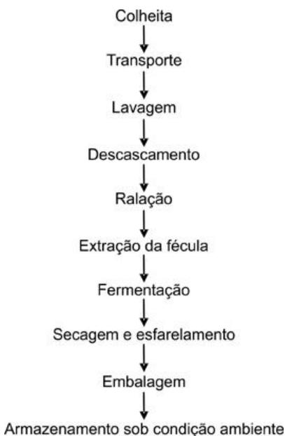
**Figura 4.** Fluxograma do processo de obtenção de polvilho azedo.
