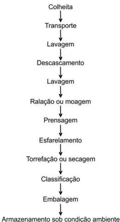
**Figura 1.** Fluxograma do processo de obtenção de farinha seca de mandioca.
