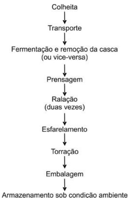
**Figura 2.** Fluxograma do processo de obtenção de farinha d'água de mandioca.
