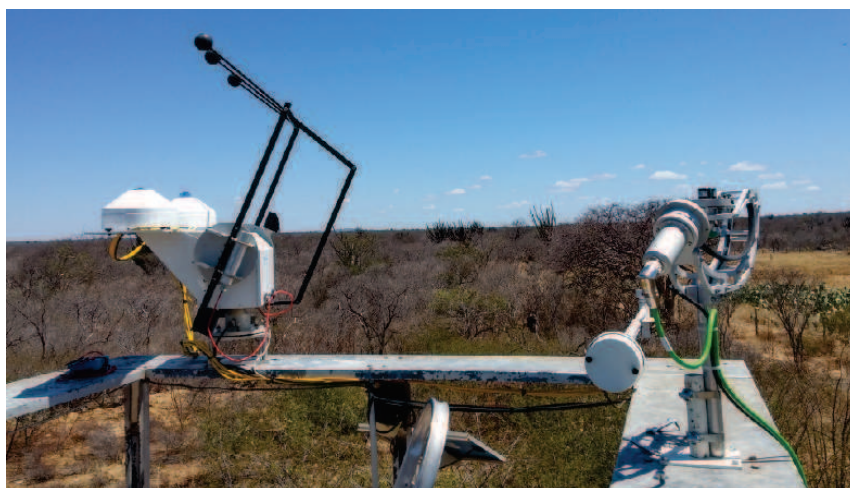
Figura 4. RSI da CSP Services instalado ao lado do seguidor com pireliômetro e piranômetro sombreado da estação Sonda em Petrolina, PE.
