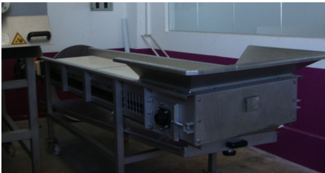
Figura 2. Foto de mesa de seleção que deve ser utilizada para a retirada de uvas danificadas antes de entrarem para a máquina desengaçadora/esmagadora.
