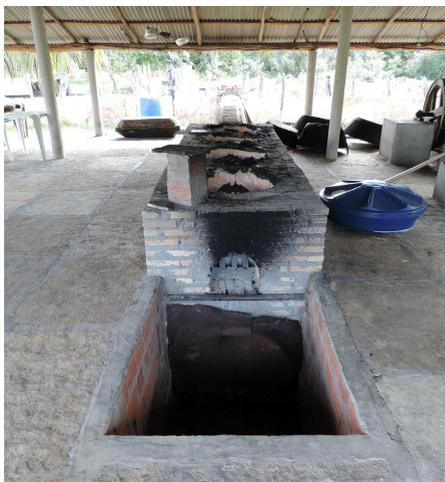
**Figura 3.** Vista de uma fornalha artesanal para a fabricação de rapadura no município de Boa Hora, PI.
