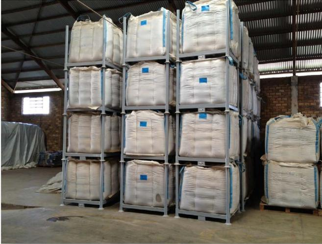
**Figura 35.** Sistema de sacolões ou “big-bags” utilizados para a armazenagem da semente de soja.
