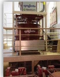
Figura 46. Equipamentos utilizados para o Tratamento Industrial de Sementes (TIS).
