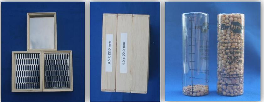
**Figura 48.** Kit para avaliação de dano mecânico em sementes de soja, ilustrando o copo medidor usado para a determinação do percentual de sementes quebradas (bandinha) de soja durante a colheita.
