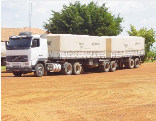
**Figura 44.** Caminhão bi-trem, utilizando lona de coloração clara, usado para o transporte de semente de soja.
