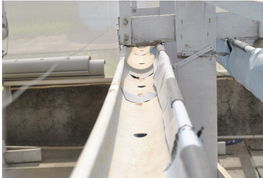
Figura 4. Orifícios da calha superior onde são fixadas as plantas.
