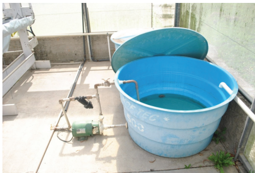
Figura 5. Depósito da solução e bombeamento e esquema de circulação da solução nutritiva, em circuito fechado, do sistema de hidropônico usado para produção de tubérculos de batata.
