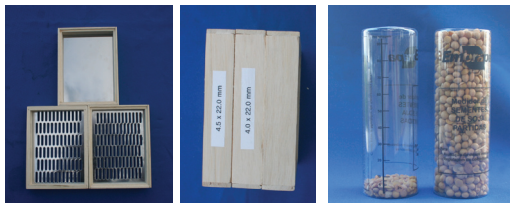
Figura 5. Kit para a avaliação do dano mecânico por sementes quebradas (bandinha).
