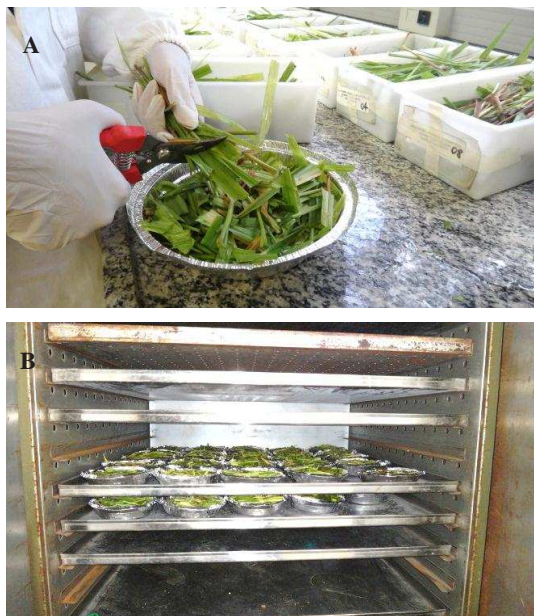
Figura 5. A: Transferência da massa verde de forrageira para recipiente de alumínio; B: Amostra de massa verde em estufa de ventilação forçada.
