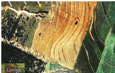
Figura 6.108 – Imagem de satélite onde aparecem terraços e bacias de retenção ao redor de uma voçoroca e ao longo da estrada (parte inferior da imagem) em área de plantio no Estado do Mato Grosso.
