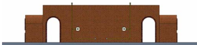
Figura 8.3 – Desenho esquemático de um forno paulistinha.
