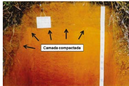
Figura 6.31 – Representação da compactação do solo e do crescimento vegetal.
