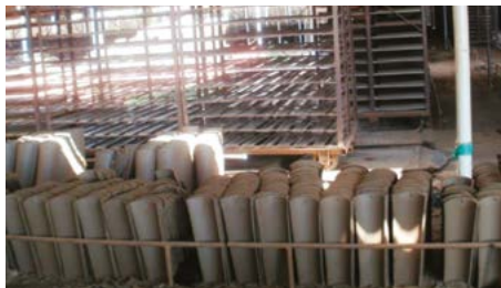
Figura 7.13 – Secagem natural de telhas em galpão (prateleiras) no Baixo-Açu.
