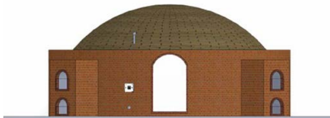
Figura 8.4 – Desenho esquemático de um forno abóbada.
