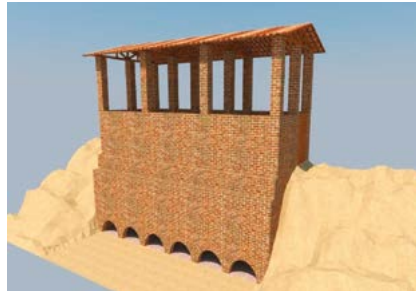
Figura 8.1- Forno intermitente de chama direta tipo caipira.
