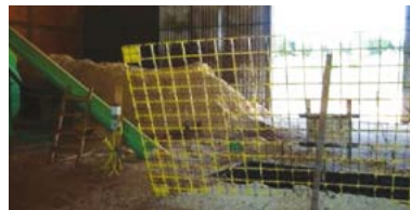
Figura 10.12 – Os resíduos são empurrados pela moega (no chão) para a peneira e o moinho através da tubulação verde.
