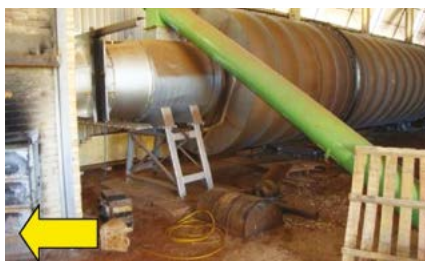
Figura 10.15 – o resíduo moído é levado, através da tubulação verde, até o secador rotativo, alimentado pelo forno pirolítico (canto esq. da foto, assinalado com seta).
