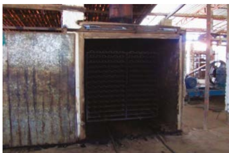
Figura 7.14 – Secagem forçada de telhas em secador tipo túnel em cerâmica no Município de Currais Novos/RN.
