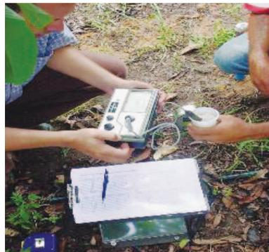
**Figuras 19 e 20** - Poço de observação do lençol freático posicionado na parte baixa da topossequência, indicando condutividade elétrica =  $4,1 \text{ dS m}^{-1}$ .
