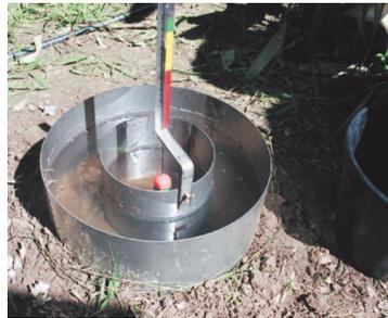
Figuras 27 e 28 - Vista dos anéis de infiltração sendo abastecidos. (Perímetro Formoso A – Bom Jesus da Lapa/BA).
