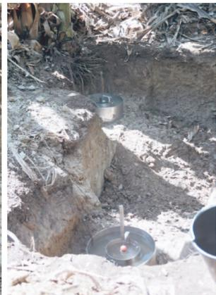
Figuras 30 e 31 - Teste de infiltração na camada que apresenta barreira física. Percebe-se que as raízes grossas não penetram nessa camada. (Perímetro Formoso A – Bom Jesus da Lapa/BA).
