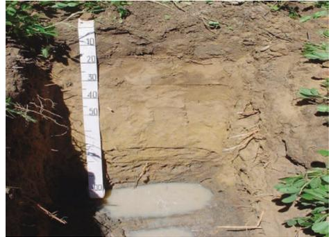
Figuras 42 e 43 - Detalhes de drenos entupidos instalados na camada barreira, mostrando a consequente elevação do lençol freático. Projeto Brígida – Santa Maria da Boa Vista/PE.
