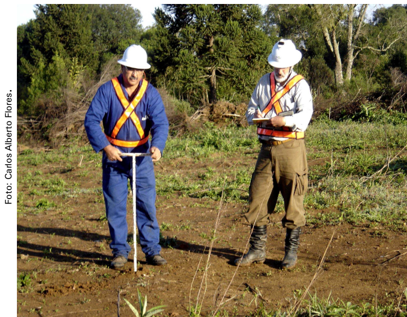
Figura 6. Tradagem do solo até 1,20 metros de profundidade, num ponto da grade de coordenada para verificação da classe de solo (mapeamento).
