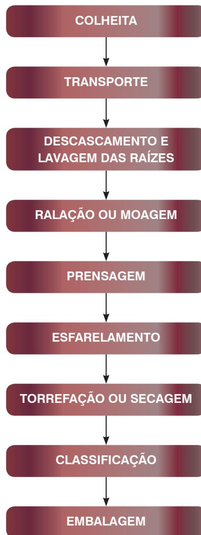
**Figura 1.** Fluxograma do processo de obtenção de farinha de mandioca.
