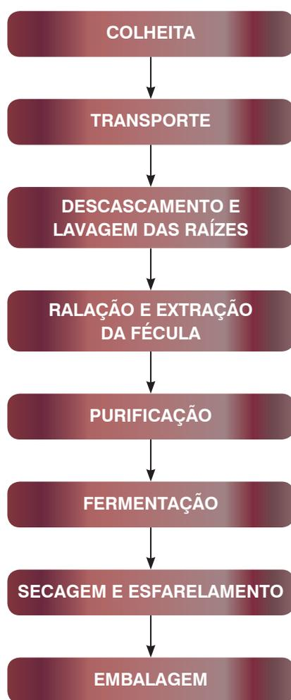
**Figura 3.** Fluxograma do processo de obtenção de polvilho azedo.
