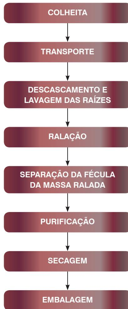
**Figura 2.** Fluxograma do processo de obtenção de polvilho doce.
