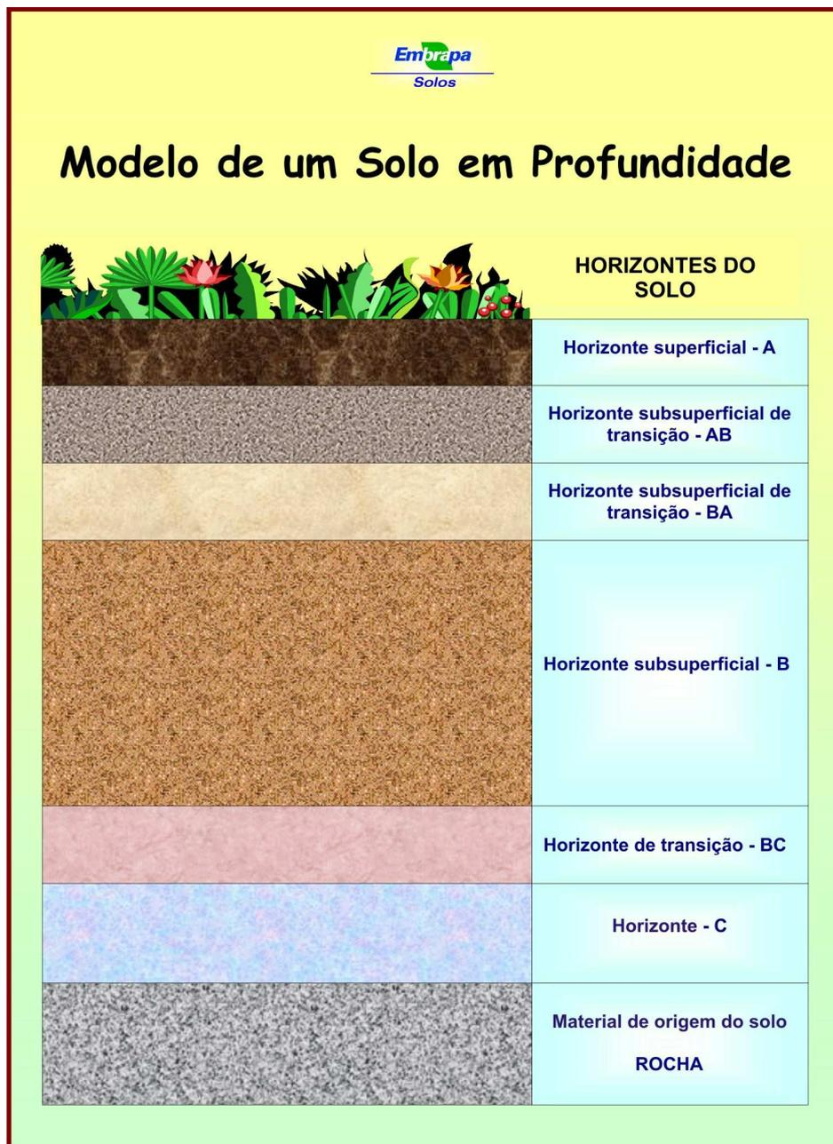
Figura 2 – Modelo da distribuição dos horizontes de um solo originado do intemperismo de uma rocha.
