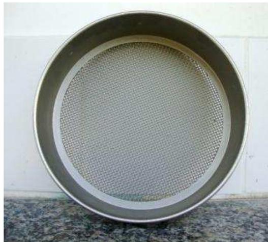
Figura 48 – Peneira com malha de 2 mm.
