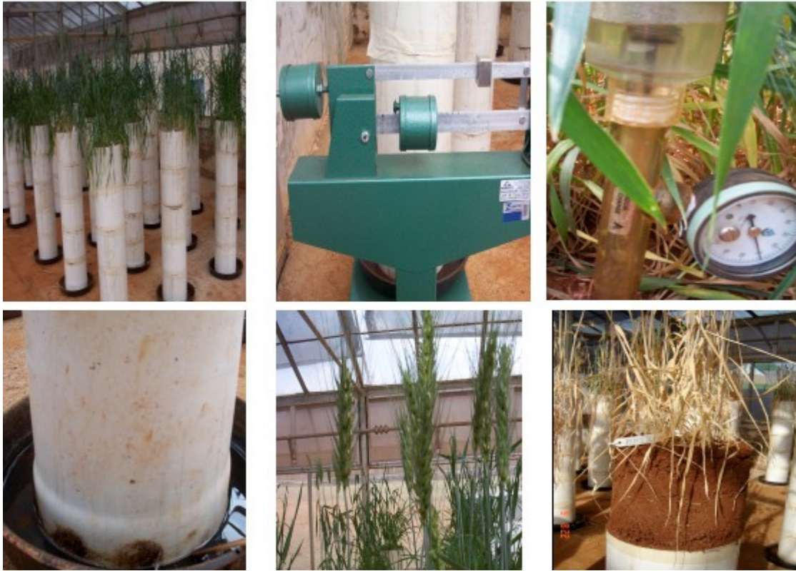
Fig. 15. Detalhes do experimento conduzido em casa de vegetação para avaliação de metodologia para aplicação e monitoramento de estresse hídrico na cultura de trigo sob condições controladas. Santo Antônio de Goiás, 2006. Detalhes na seqüência: Tubos de PVC como unidade experimental, controle da umidade pelo peso, controle da umidade pelo tensiômetro, detalhe das espigas e trigo na fase de colheita.
