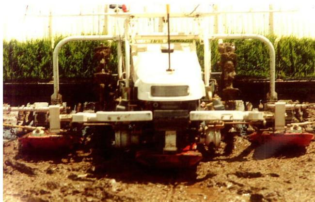
**Fig. 3.** Máquina transplantadora de mudas de arroz irrigado na Embrapa Clima Temperado, Pelotas, RS. 2002.
