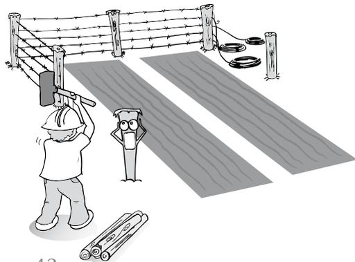
a 5 fios de arame farpado, fixados em palanques de madeira ou concreto fincados no chão a cada 2 m.
