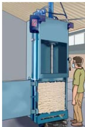
**Figura 8.** Prensa hidráulica com o fardo de algodão, pronto para ser amarrado.
