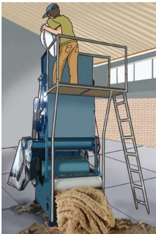
**Figura 5.** Parte traseira da miniusina, onde é possível visualizar a plataforma de abastecimento e a saída da fibra em forma de manta.
