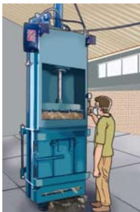
**Figura 7.** Detalhe da prensa hidráulica no momento em que ocorre o processo de prensagem da fibra de algodão colorido.
