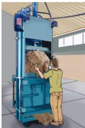
**Figura 6.** Abastecimento da prensa hidráulica, com a fibra de algodão colorido.
