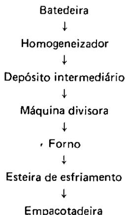
**Figura 9** – Fluxograma da obtenção de bolos industriais.
