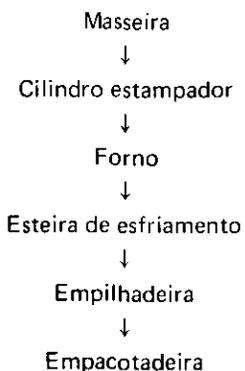
**Figura 8** – Fluxograma da obtenção de biscoitos doces amanteigados (Pi-coco)
