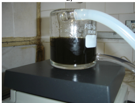
Fig. 14. Condições hidrodinâmicas do reator com óleo residual do POME: a) vista superior; b) vista lateral.
