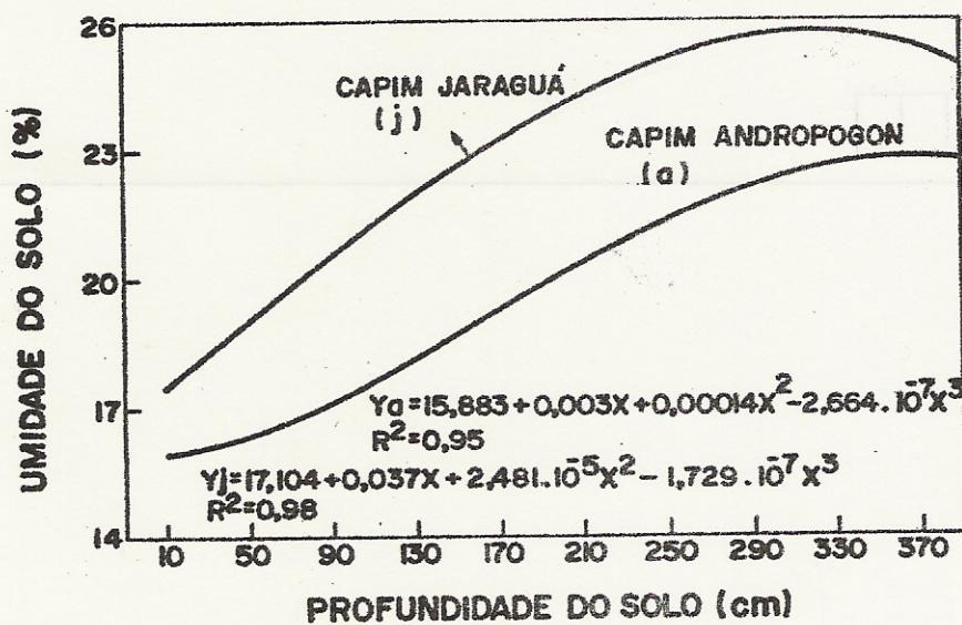
FIG. 2- Umidade dos solos cultivados com os capins Andropogon e Ja raguá de 20 em 20cm da superfície até 4m de profundidade.
