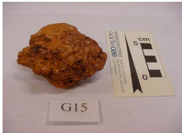
Foto 27: Amostra de granitóide da Suíte Serra da Providência bastante alterado.
