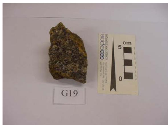
Foto 31: Amostra de granito pórfiro rosado Serra da Providência.
