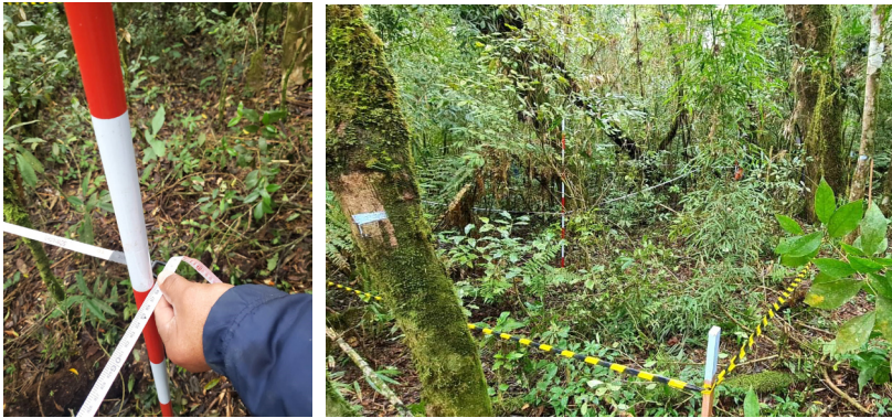
Figura 10. Uso de trenas e balizas na instalação de subparcela temporária a partir de um dos vértices externos, em direção ao interior da parcela (fita zebraada na foto) para a avaliação da classe de regeneração I (RNI).
