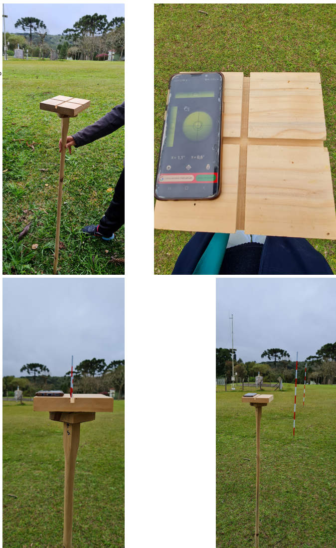
Figura 3. Utilização da cruzeta para visualização e enquadramento das balizas e consequente fechamento do perímetro e dos demais vértices da UA, sendo a plataforma nivelada mediante uso de aplicativo para fone celular..
