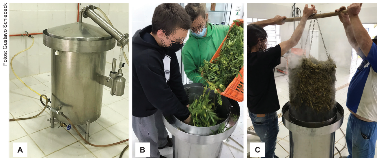
Figura 2. Aspecto externo do destilador utilizado na Estação Experimental Cascata para obtenção de óleo essencial de Tagetes minuta (A), colocação da biomassa beneficiada (B) e retirada da biomassa no final da extração (C).
